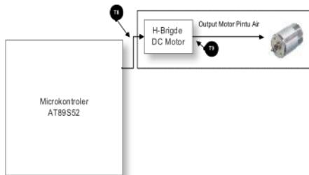
Gambar 7. Blok Pengukuran untuk output ke motor DC pintu air
