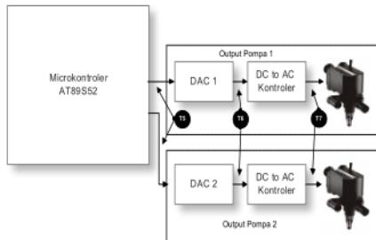
Gambar 6. Blok Pengukuran untuk output ke pompa 1 dan 2
