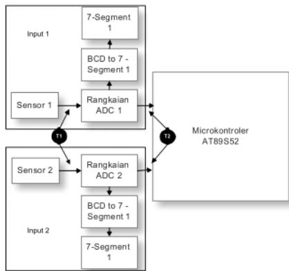
Gambar 5. Blok Pengukuran untuk Input dari sensor 1 dan 2
