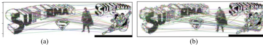
Gambar 2. Visualisasi pasangan korespondensi keypoint menggunakan algoritma SIFT dan SURF
