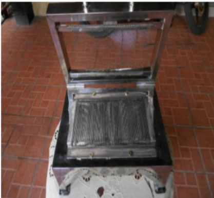
Gambar 2: Alat Pemotong Lontongan Adonan Kerupuk
