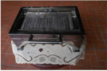
Gambar 1: Bentuk Fisik Alat Pemotong Lontongan Adonan Kerupuk
