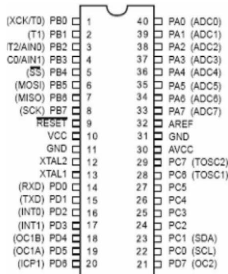
Gambar 2.1 Konfigurasi Atmega 8535
