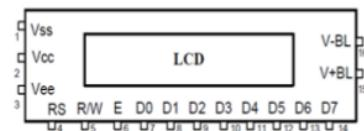
Gambar 3.7 Rangkaian Display LCD 16 x 2
