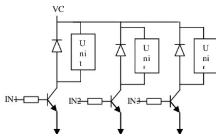
Gambar 3.3 Rangkaian Driver Relay
