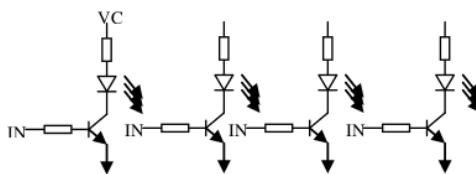
Gambar 3.4 Rangkaian Display LED
