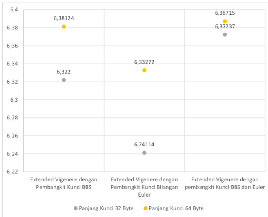
Gambar 7. Entropi rata rata Extended Vigenere dengan pembangkit kunci BBS dan Bilangan Euler.
