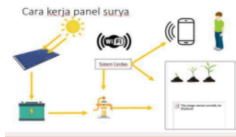
Gambar 6 : Cara Kerja Panel Surya
